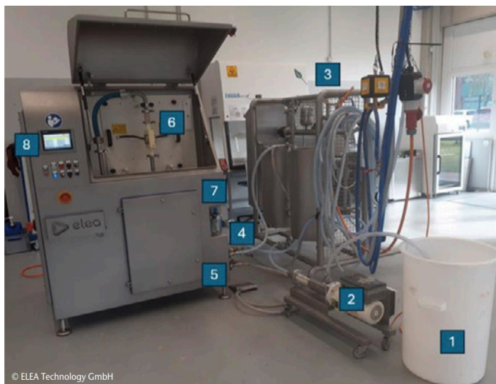
Abb. 6: Versuchsaufbau mit der PEF-Anlage PEFPilot™ Dual
