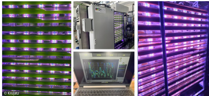
Abb. 4: Aufbau und Betrieb des 200-L-Forschungsmoduls (PACT200, PUEVIT GmbH, Dresden) des Innovationsraums NewFoodSystems Integration wassergekühlter LED-Leuchten sowie Datenaufnahme aus dem Prozess
